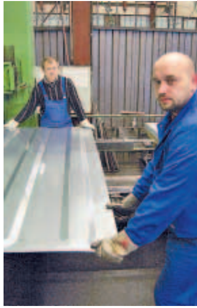
Dünne Bleche für Container gesucht: Die Metallbauer Maik Walter, vorne, und Viktor Keberlein bei der Herstellung eines Dachbleches mit rinnenförmigen Vertiefungen.
