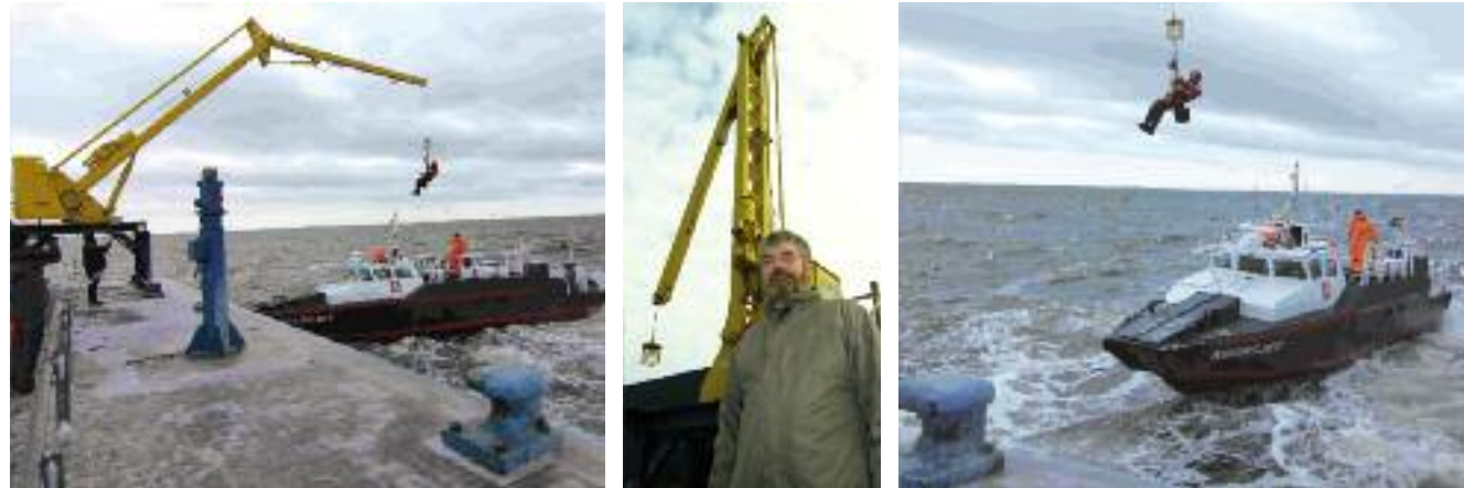
Den Praxistest machte Heinrich Duden selbst: Die Fotos zeigen das Personnel Transfer System bei einem der Versuche an der Küste. Später soll der Kran an Offshore-Windkraftanlagen montiert werden, um Wartungspersonal vom Schiff auf die Arbeitsplattform zu hieven.
