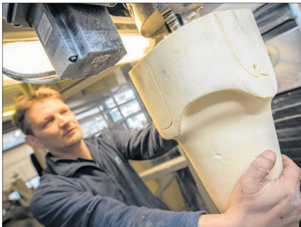
Großer Fortschritt in der Prothesentechnologie: Dennis Walter von Proolutions bei der Herstellung eines Prothesenschäftes.
